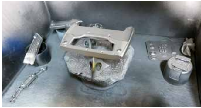
Silberschmiede: Die Druckteile fürs Fahrerhaus sind mit lichtundurchlässigem Silberlack grundiert
