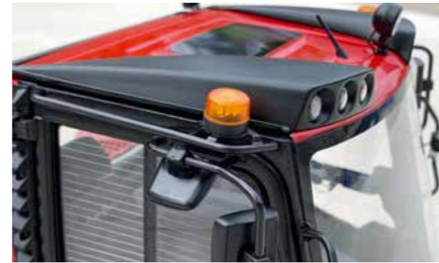
Um auch in Sachen Beleuchtung möglichst nah ans Original zu kommen, baute und kürzte der Autor die Rundumkennleuchten von Pistenking auf die flache Version Comet S um
