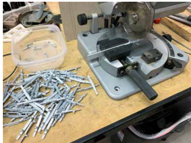
Beim Kettenbau wurden die Spurstegel mit der Kappsäge getrennt
