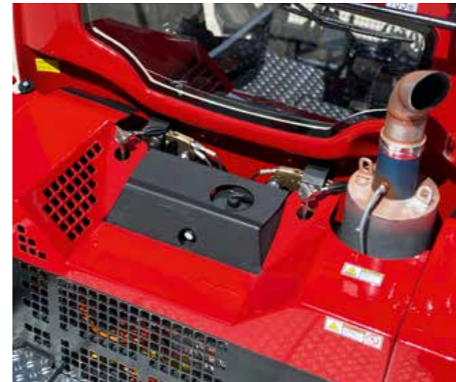
Unter dem „Rucksack“ musste die gesamte Elektronik Platz finden
