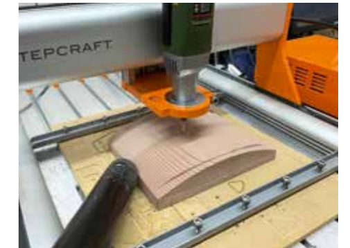
Für die Frontscheibe entstand eine Form auf der Stepcraft CNC-Fräse, die verschliffen, lackiert und poliert werden musste
