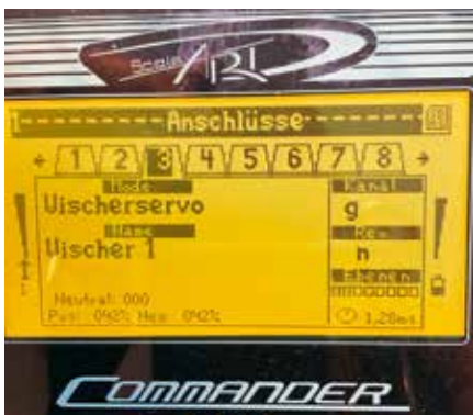
Die Scheibenwischer lassen sich über ein für den Wischerbetrieb programmiertes Servo steuern
