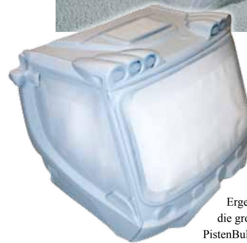
Abkleben der Fahrerkabine und hellgraue Grundierung
